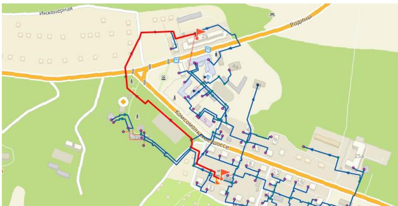
Рисунок 2.33 - Путь теплоносителя по направлению от котельной № 14 до потребителя «ул.Комзина 29»
