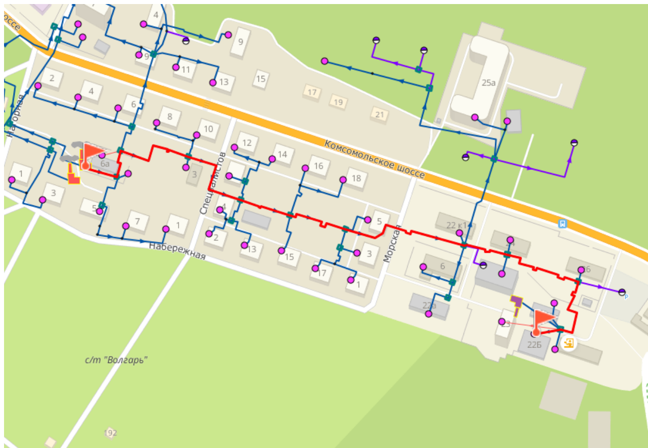
Рисунок 2.29 - Путь теплоносителя по направлению от котельной №14 до потребителя «ул. Комзина 29»
