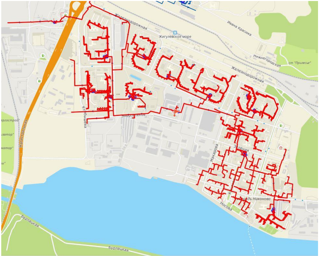
Рисунок 7.7 – Зона теплоснабжения котельной №8, переключаемая на время восстановления
