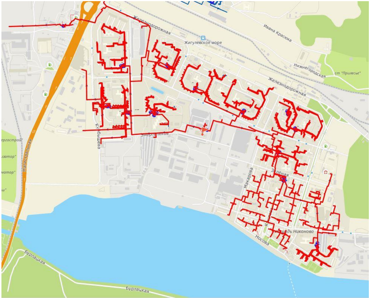
Рисунок 7.7 – Зона теплоснабжения котельной №8, переключаемая на время восстановления
