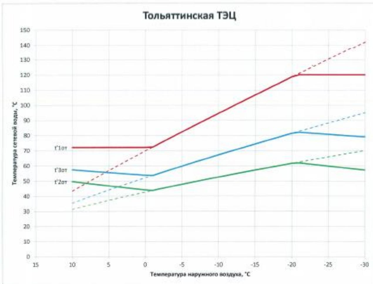
**Рисунок 2.23 – Утвержденный температурный график регулирования отпуска тепла от Тольяттинской ТЭЦ и гидравлические режимы работы тепловых сетей на отопительный сезон 2019-2020 годов (графическая форма)**
