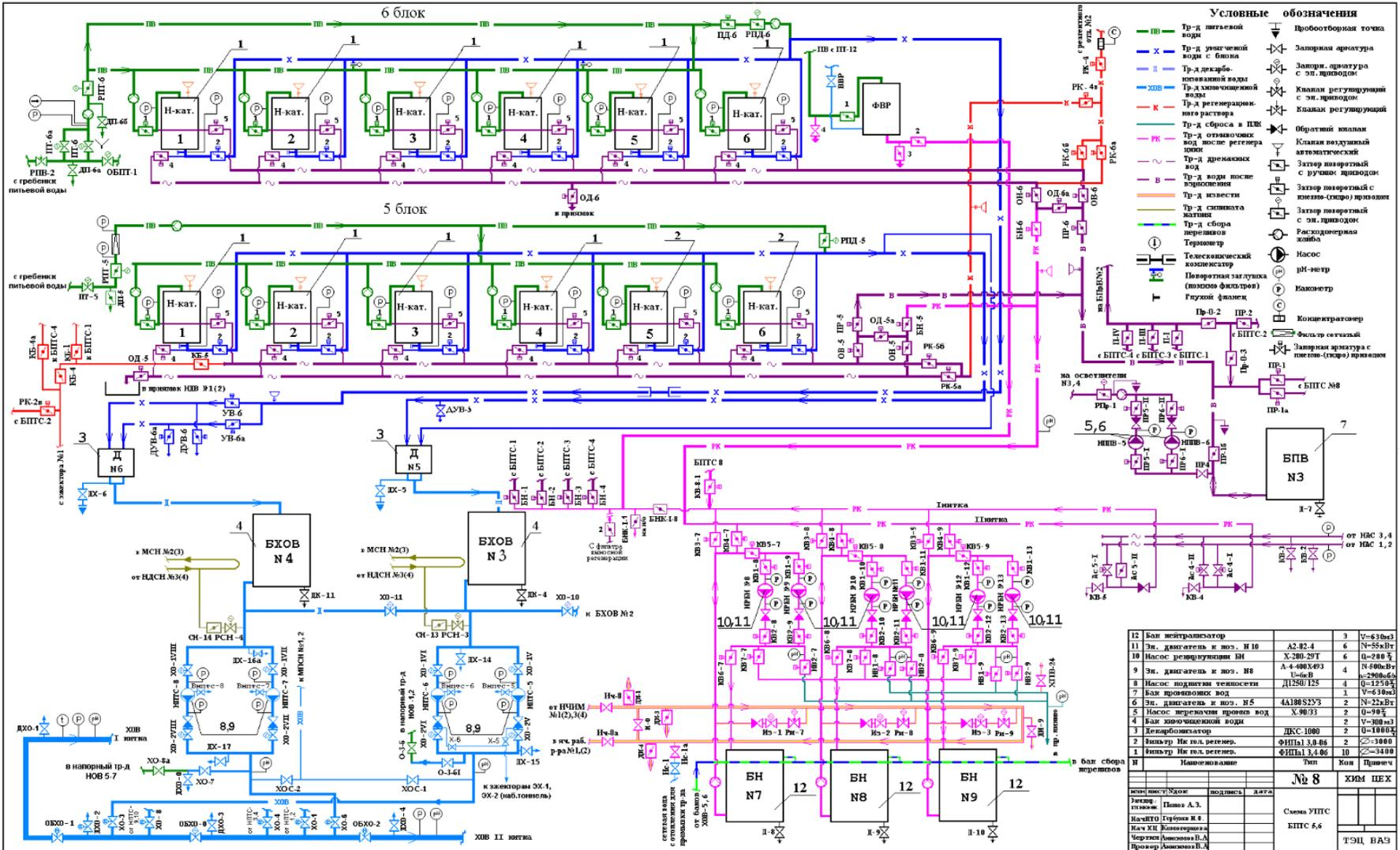
Рисунок 2.17 – Схема установки подпитки теплотрассы БПТС 5, 6 ТЭЦ ВАЗа
