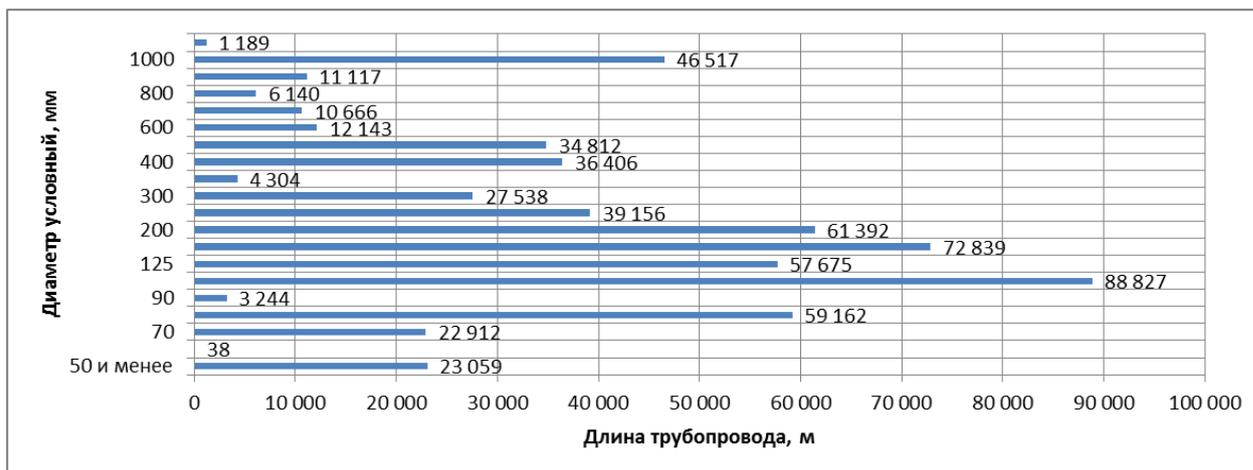
Рисунок 3.15 – Распределение протяженности трубопроводов тепловых сетей АО «ТЕВИС» по диаметрам
