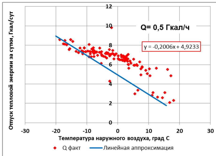
Рисунок 5.25 – Определение фактического отпуска тепловой энергии котельной №7 за отопительный период 2019 г.
