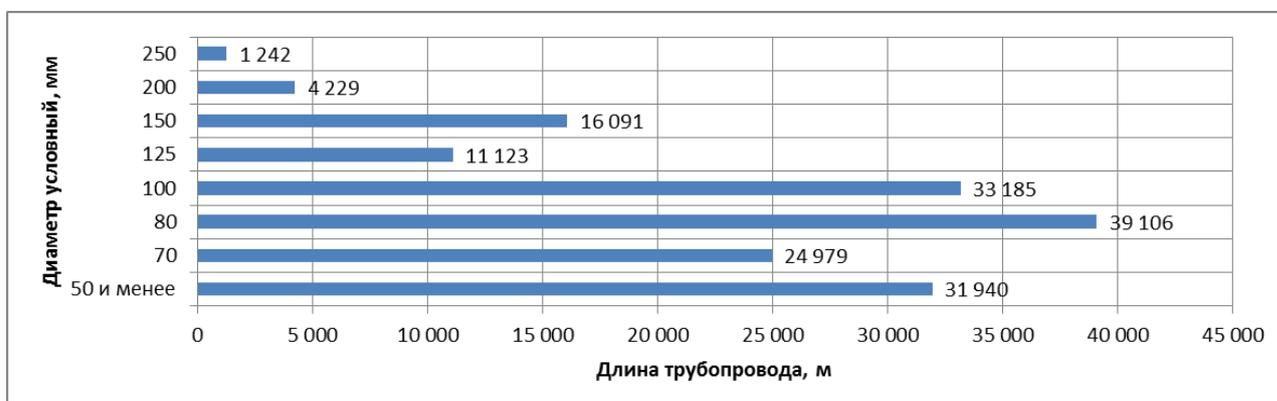
Рисунок 3.7 – Распределение протяженности трубопроводов сетей гвс по диаметрам
