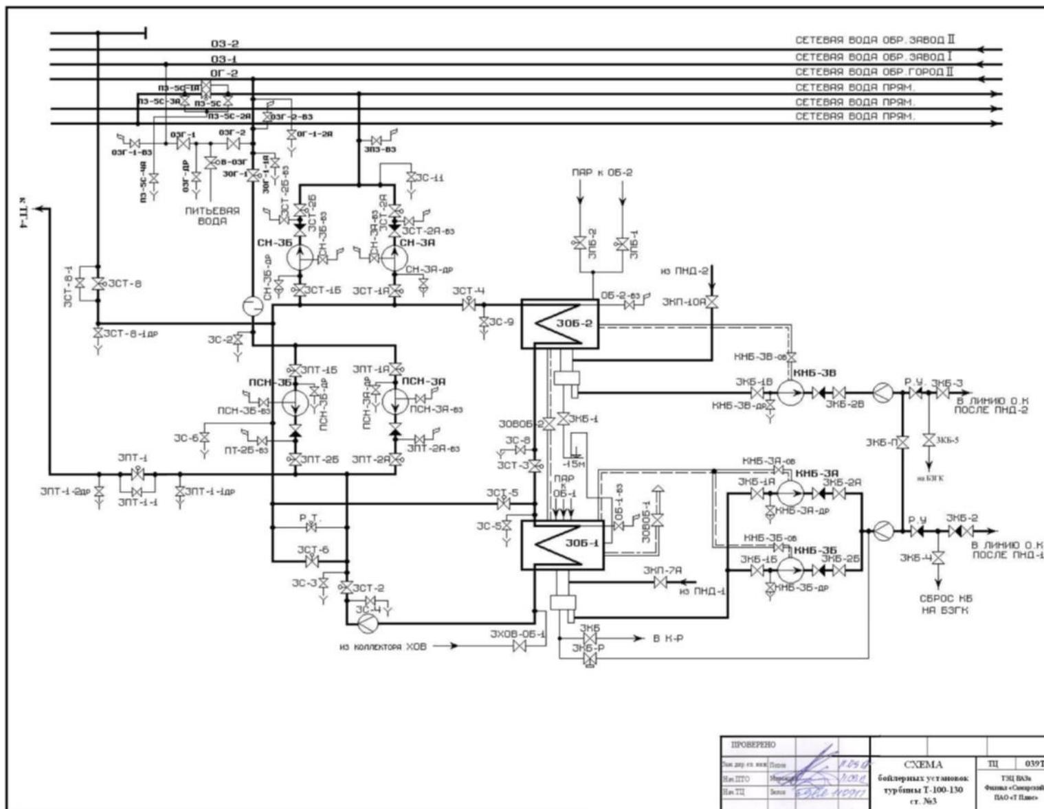
Рисунок 2.3 – Схема бойлерной установки ТГ-3 ТЭЦ ВАЗа
