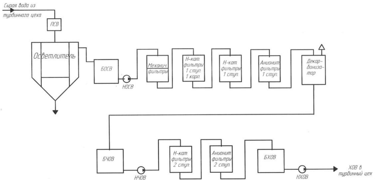
Рисунок 2.27 – Принципиальная схема ХВО-2 ТотьЭЦ
