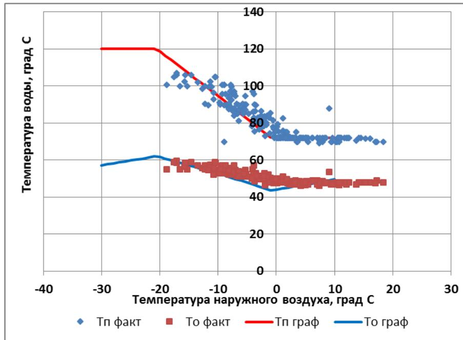
Рисунок 5.16 – Температурный график и температура сетевой воды котельной №8
