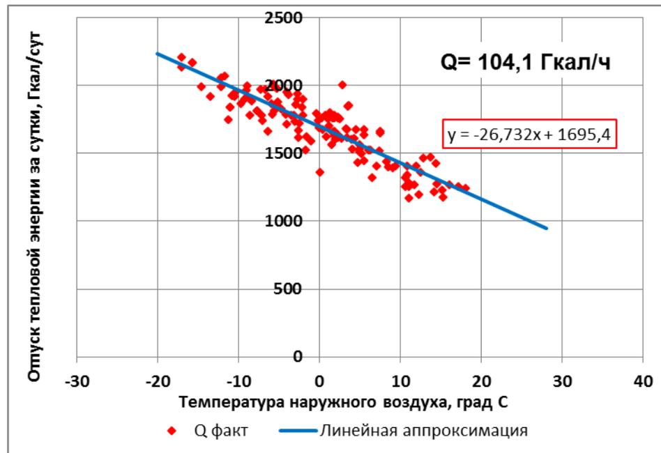
Рисунок 5.13 – Определение фактического отпуска тепловой энергии ТЭЦ ВАЗа «Технология на ВАЗ» за отопительный период 2019 г.
