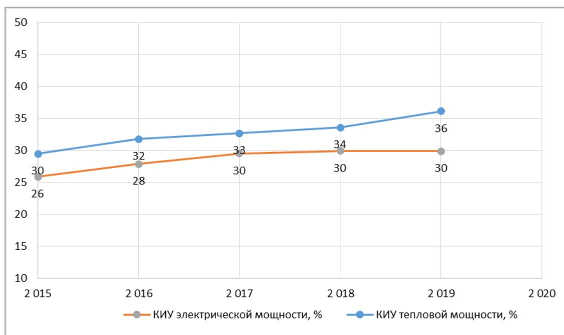
**Рисунок 2.25 – Коэффициенты использования электрической и теплофикационной мощности ТoТЭЦ**
