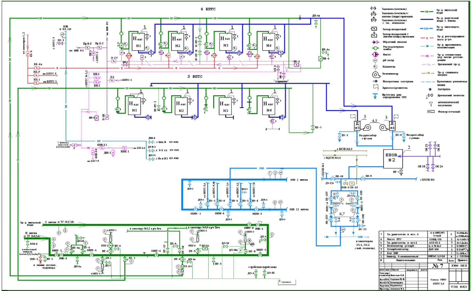
Рисунок 2.16 – Схема установки подпитки теплосети БПТС 3, 4 ТЭС ВАЗа
