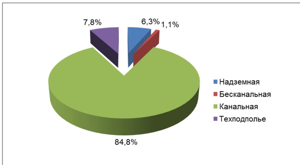
Рисунок 3.16.1– Распределение протяженности трубопроводов тепловых сетей по типу прокладки
