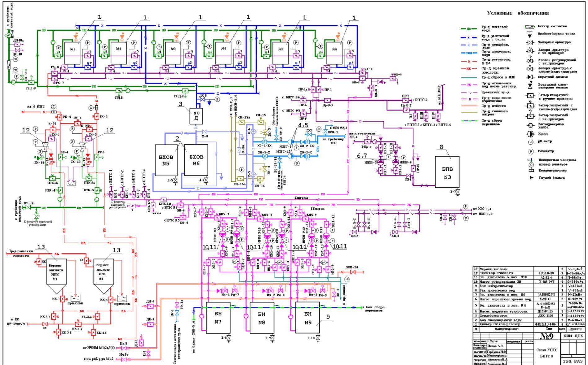
Рисунок 2.18 – Схема установки подпитки теплосети БПТС 8 ТЭЦ ВАЗа
