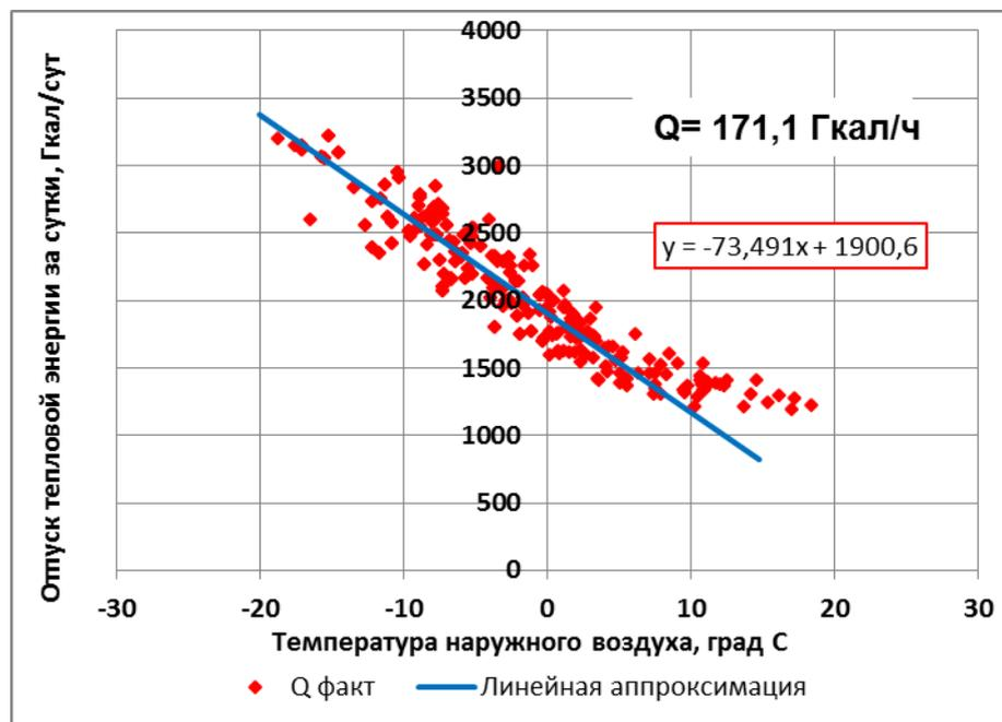
Рисунок 5.21 – Определение фактического отпуска тепловой энергии котельной №2 за отопительный период 2019 г.
