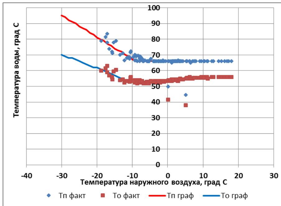
Рисунок 5.19 – Температурный график и температура сетевой воды котельной №7
