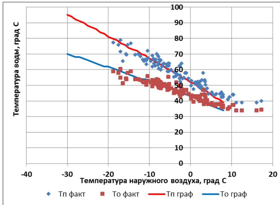
Рисунок 5.20 – Температурный график и температура сетевой воды котельной №14
