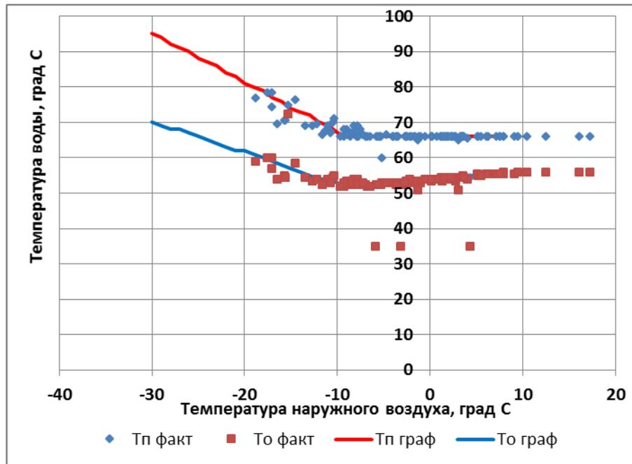
Рисунок 5.18 – Температурный график и температура сетевой воды котельной №4
