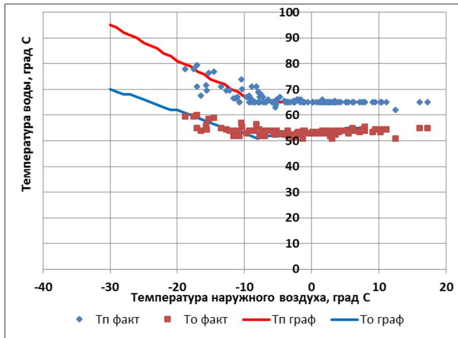
Рисунок 5.17 – Температурный график и температура сетевой воды котельной №3
