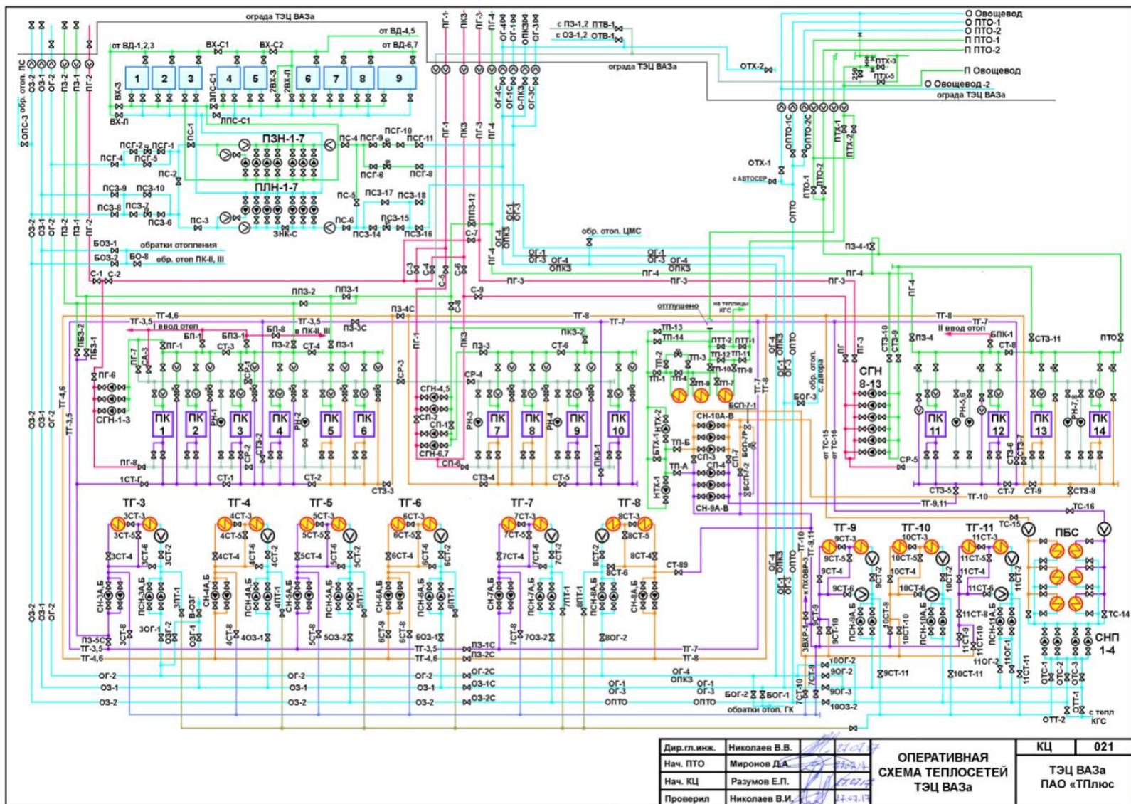
Рисунок 2.2 – Оперативная схема теплосетей ТЭЦ ВАЗа
