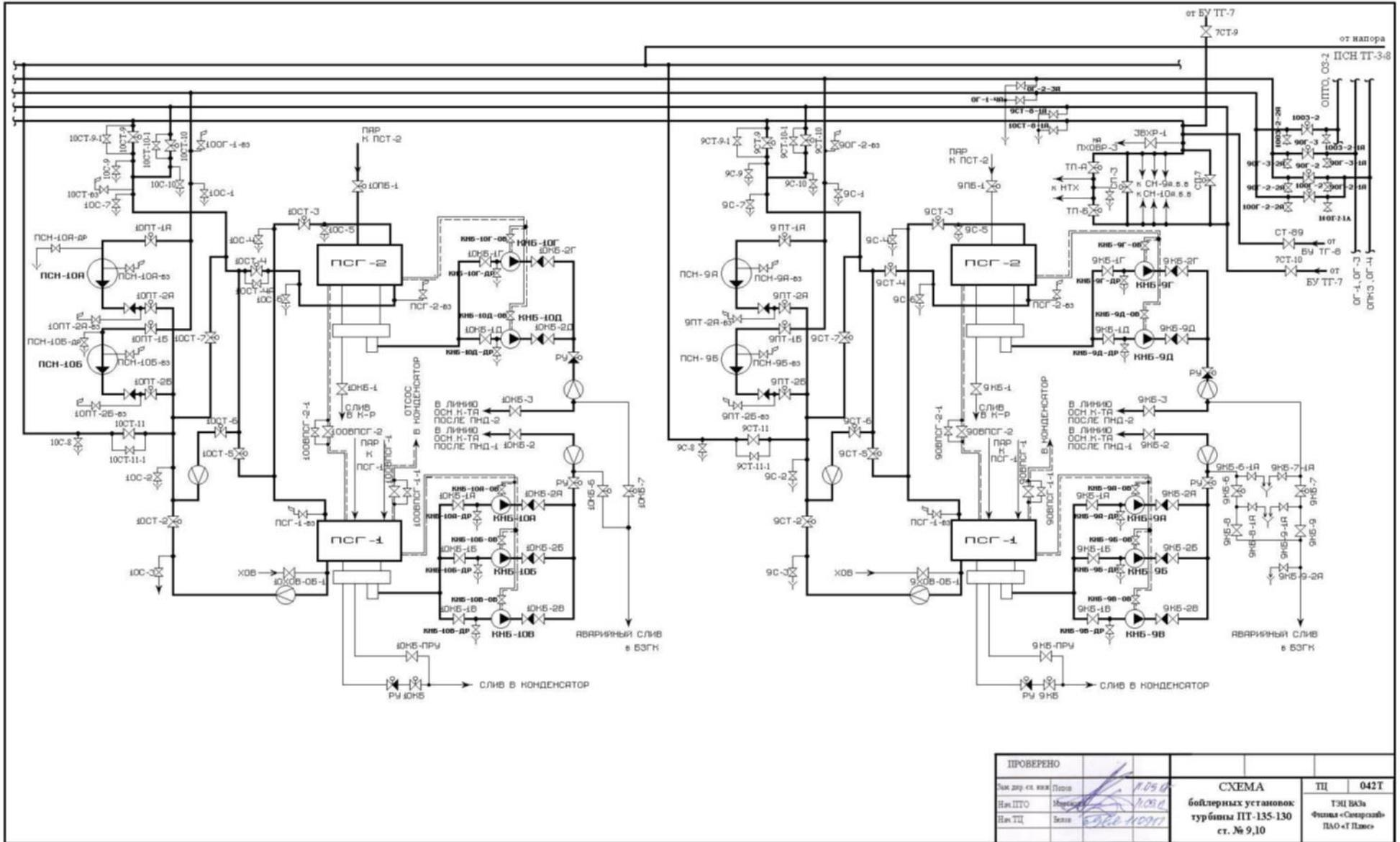
Рисунок 2.6 – Схема бойлерной установки ТГ-9 и 10 ТЭЦ ВАЗа
