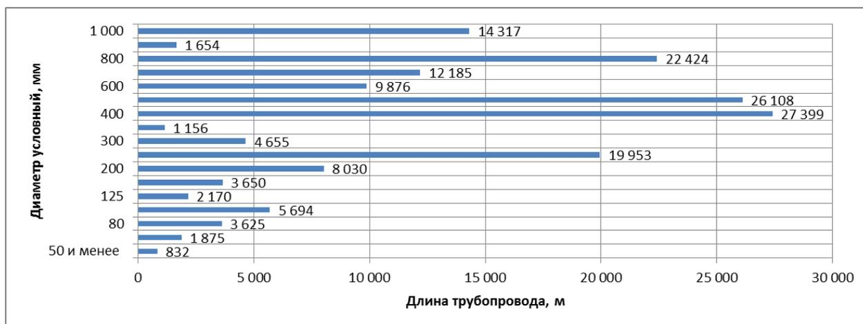
Рисунок 3.3 – Распределение протяженности магистральных трубопроводов тепловых сетей по диаметрам
