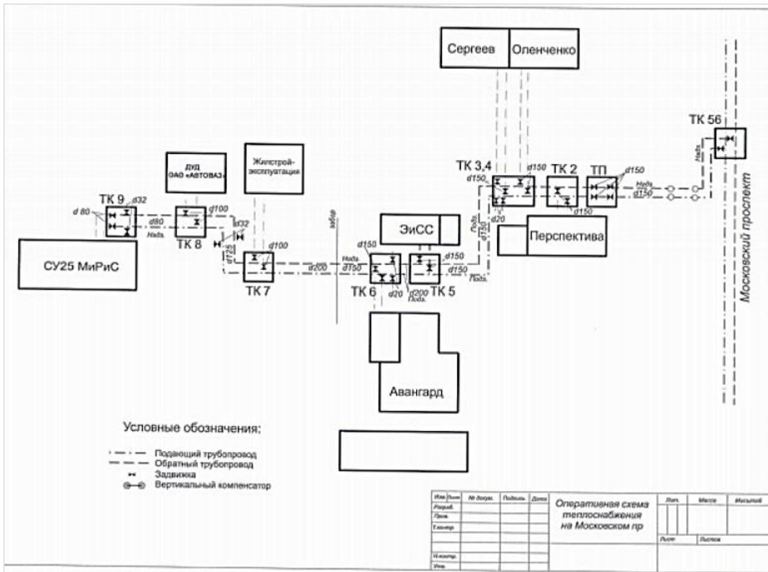
Рисунок 3.20 – Схема трубопроводов тепловых сетей, от ТК-56
