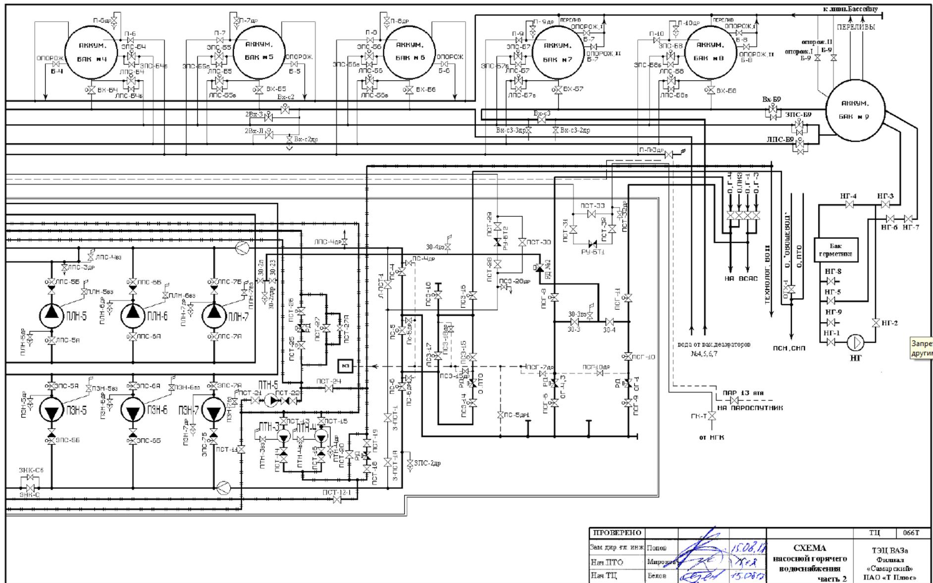
Рисунок 2.9 – Схема насосной ГВС (часть 2) ТЭЦ ВАЗа
