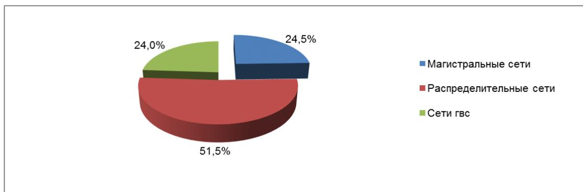
Рисунок 3.2 – Распределение протяженности трубопроводов тепловых сетей по назначению
