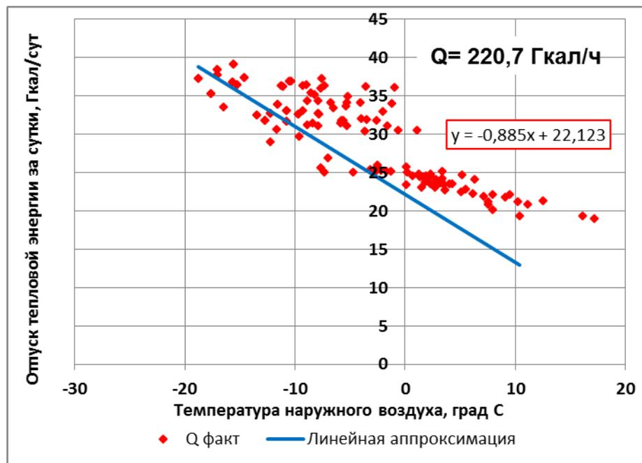
Рисунок 5.23 – Определение фактического отпуска тепловой энергии котельной №3 за отопительный период 2019 г.
