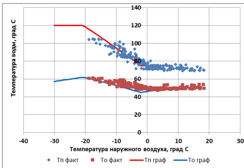
Рисунок 5.3 – Температурный график и температура сетевой воды ТпТЭЦ на «Восток ТП-3»
