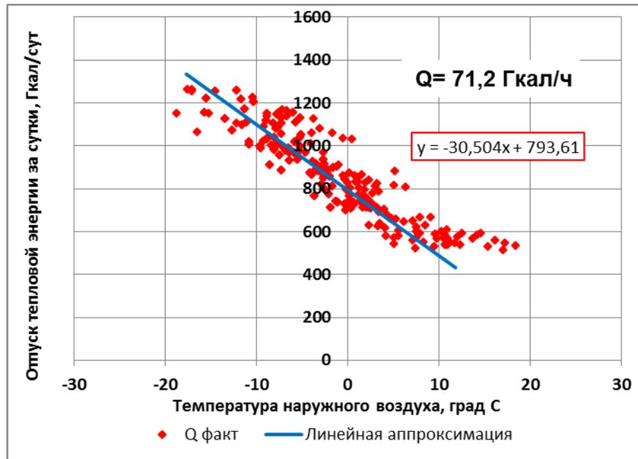
Рисунок 5.22 – Определение фактического отпуска тепловой энергии котельной №8 за отопительный период 2019 г.
