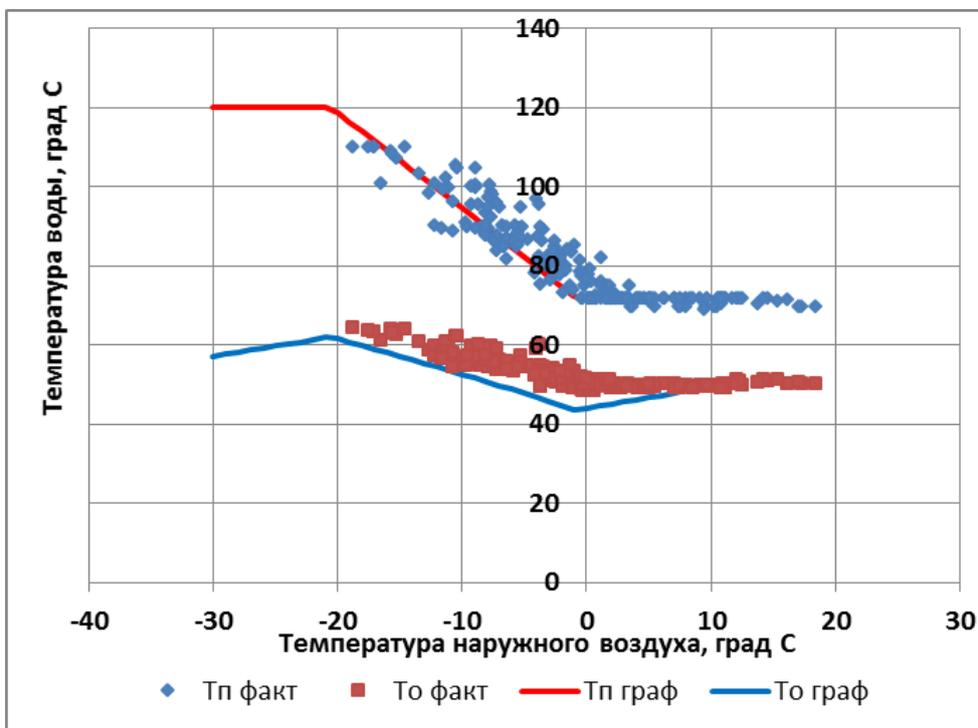
Рисунок 5.15 – Температурный график и температура сетевой воды котельной №2
