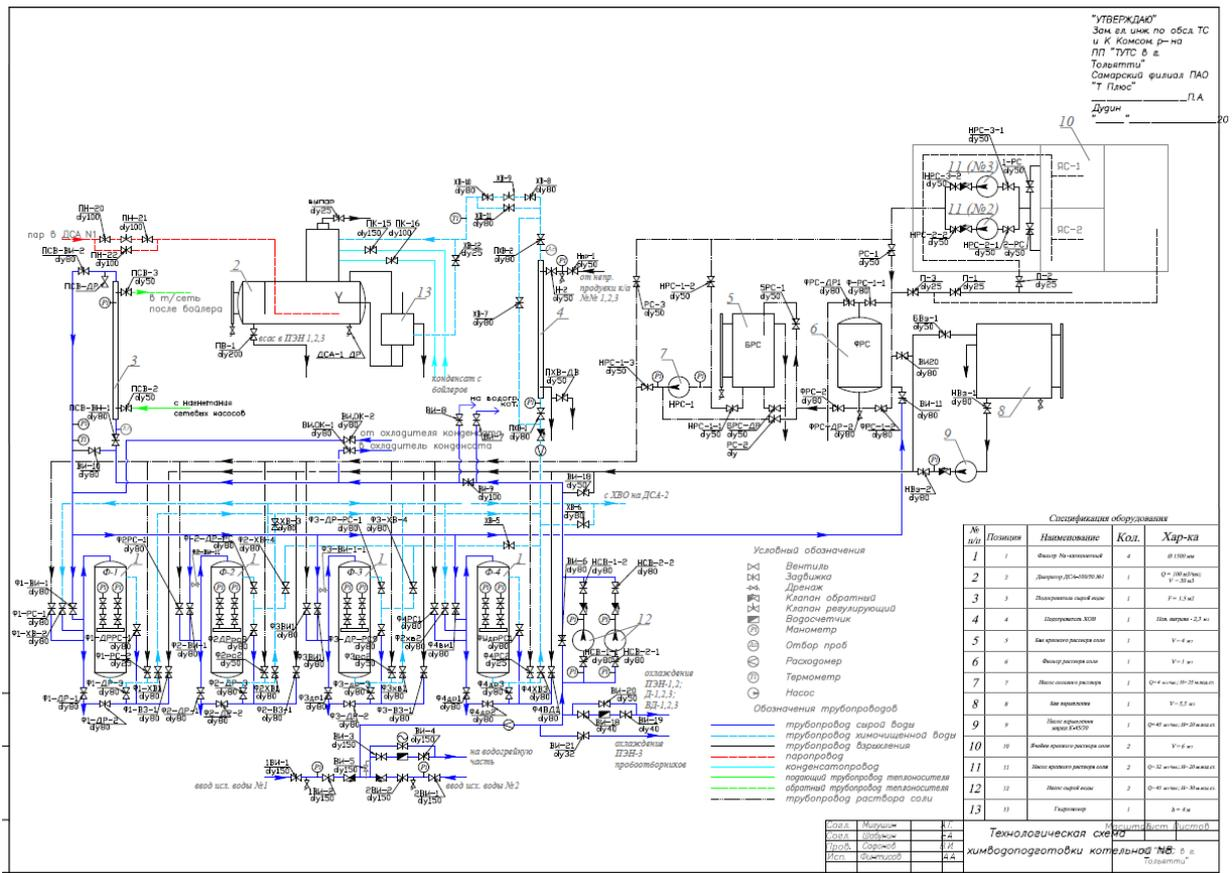
Рисунок 2.38 – Схема ХВО котельной № 8
