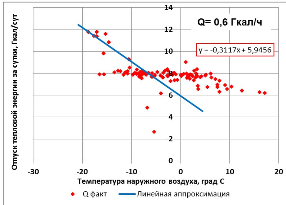
Рисунок 5.24 – Определение фактического отпуска тепловой энергии котельной №4 за отопительный период 2019 г.
