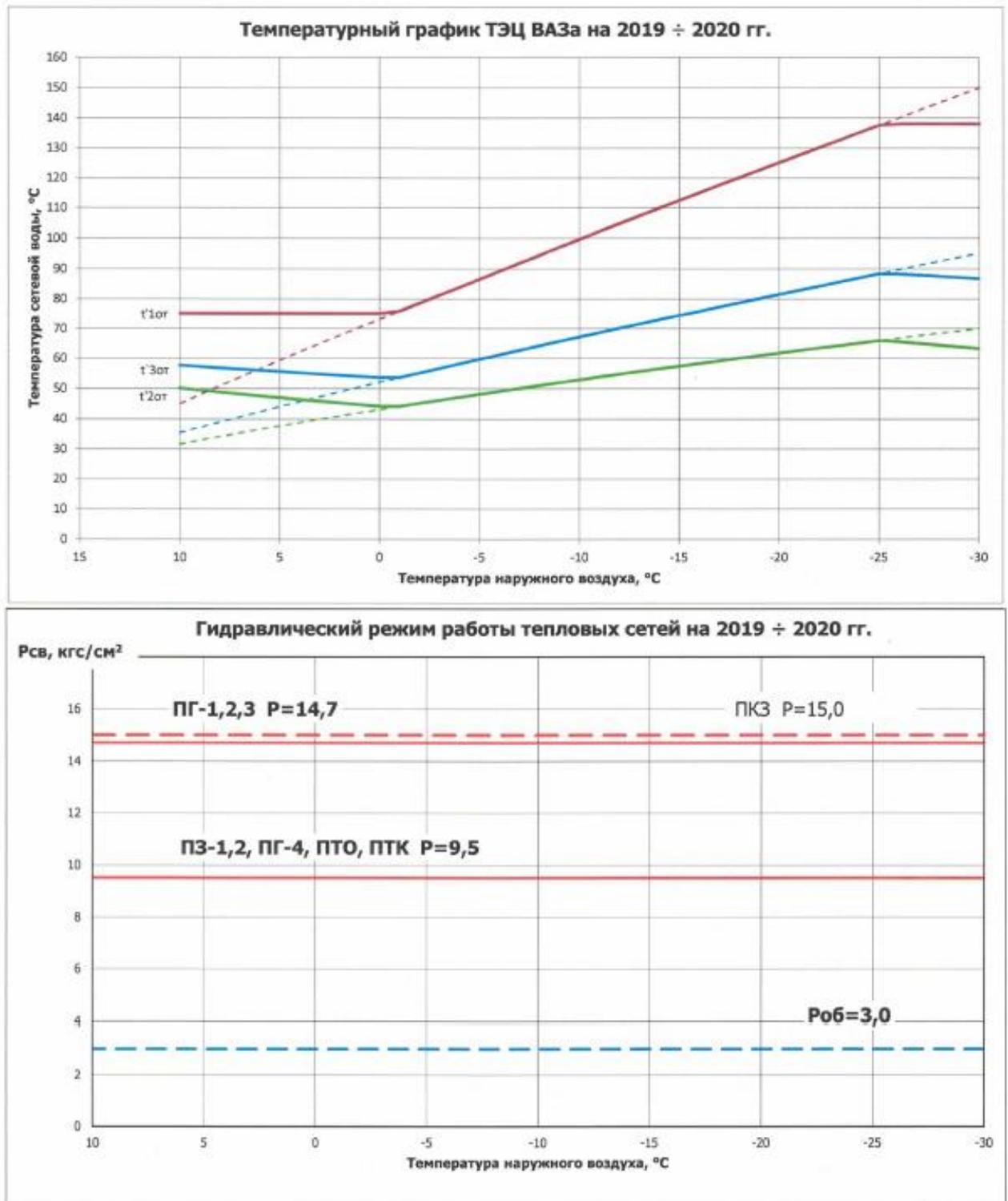
Рисунок 2.12 – Утвержденный температурный график регулирования отпуска тепла от ТЭЦ ВАЗа и гидравлические режимы работы тепловых сетей на отопительный сезон 2019-2020 годов (графическая форма)
