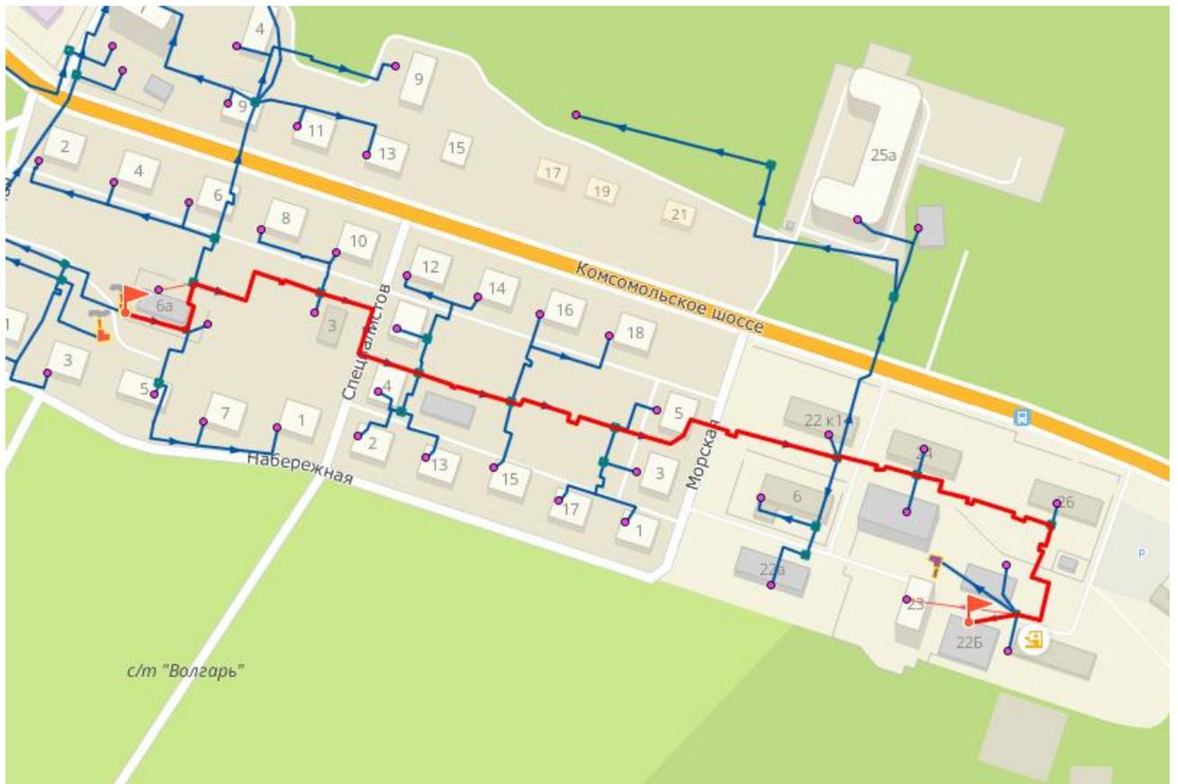
**Рисунок 2.37 - Путь теплоносителя по направлению от котельной №14 до потребителя «Комсомольское шоссе 22б»**
