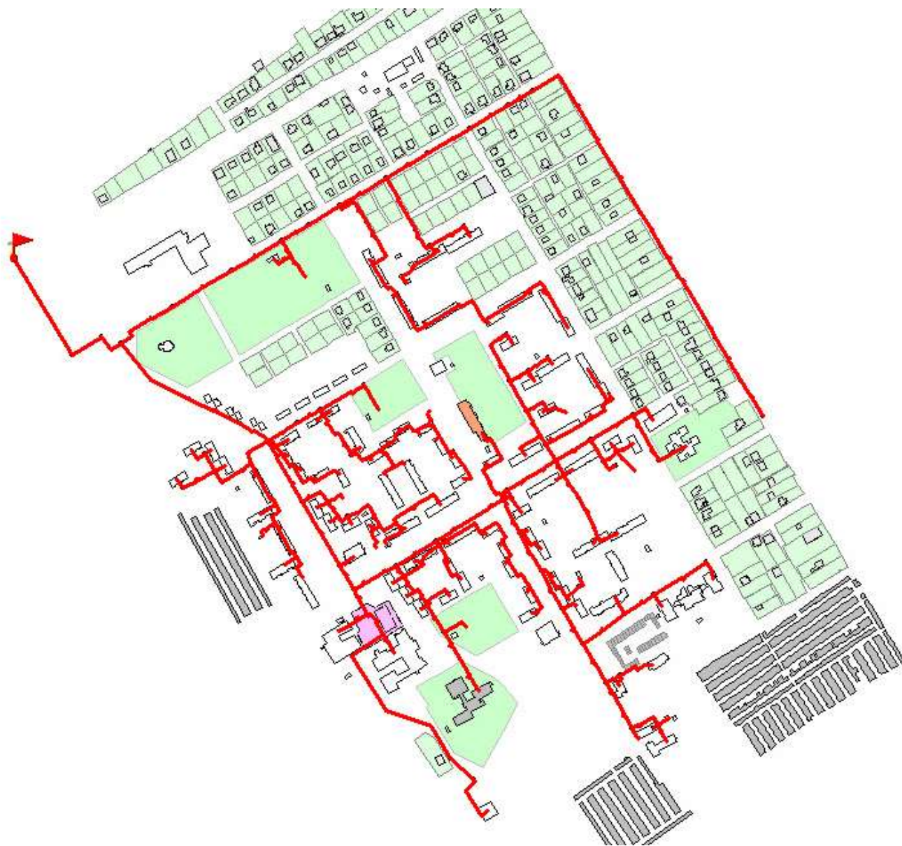
Рисунок 46 – Тепловая сеть от котельной БМК-34
