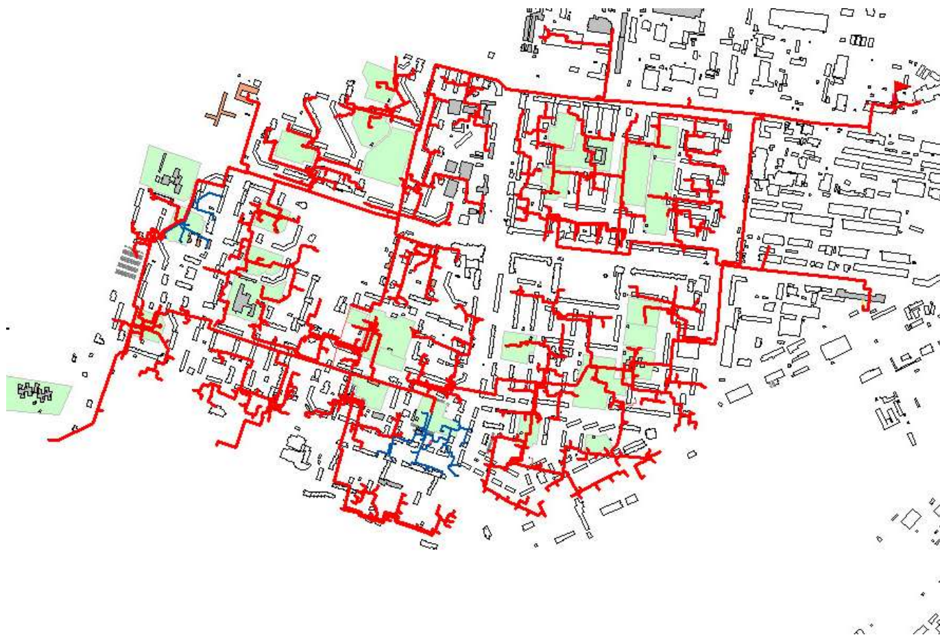
Рисунок 51 – Тепловая сеть от Котельной № 2
