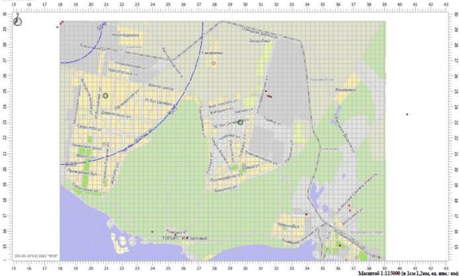
Рисунок 3.2 – Поля максимальных приземных концентраций от выбросов диоксида серы на перспективу (зимний период без учета фона) Условные обозначения: ● – источники теплоснабжения, ○ - ПНЗ
