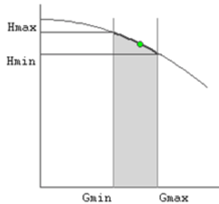
Рисунок 3.9 - Напорно-расходная характеристика насоса
