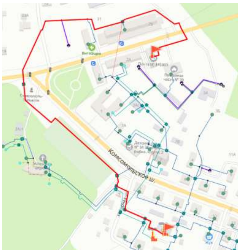
Рисунок 2.25 - Путь теплоносителя по направлению от котельной №14 до потребителя «ул. Комзина 4»
