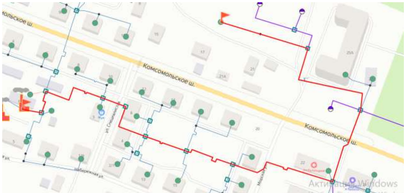
Рисунок 2.27 - Путь теплоносителя по направлению от котельной №14 до потребителя «ул. Комзина 29»
