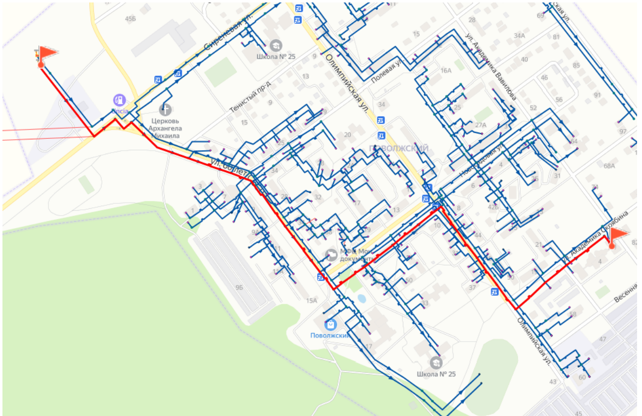
Рисунок 2.31 - Путь теплоносителя по направлению от котельной БМК-34 до потребителя «ул. Академика Скрябина 4»
