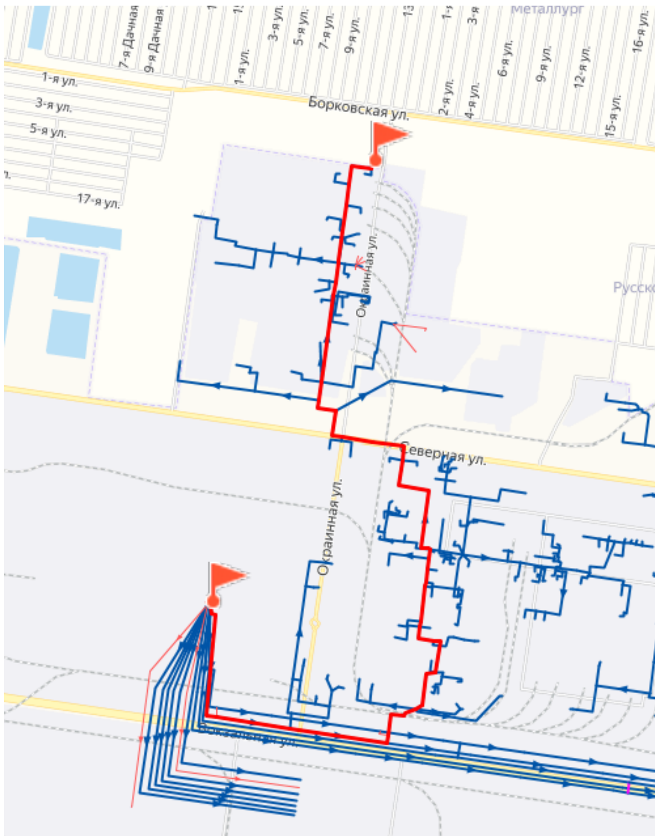
Рисунок 2.3 - Путь теплоносителя по направлению от ТЭЦ ВАЗ до потребителя «ул Окраинная 1»
