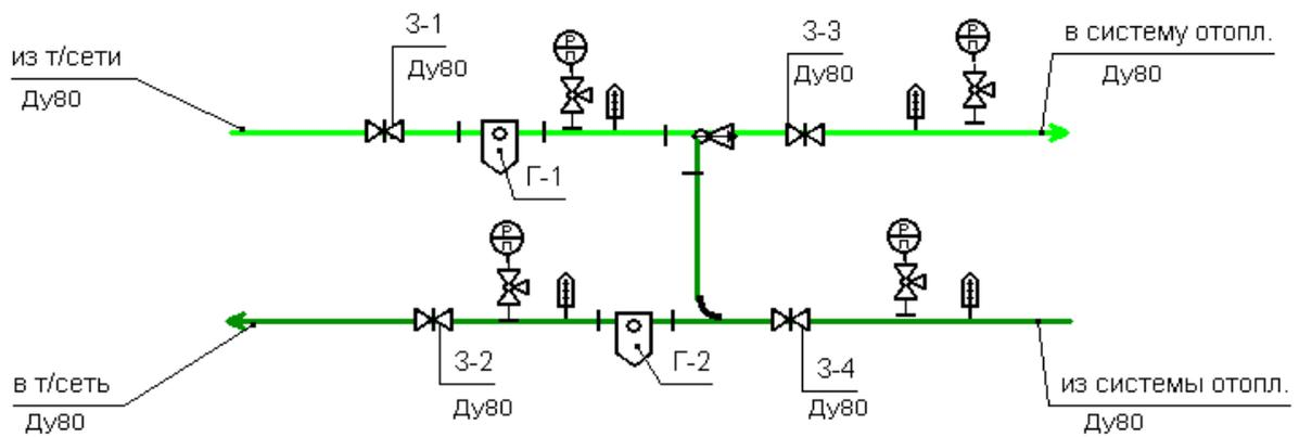
Рисунок 3.2 – Зависимое присоединение отопления (элеваторное смешение)
