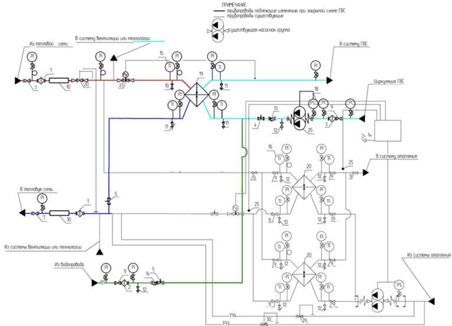
Рисунок 3.8 – Схема ИТП. Тип 3
