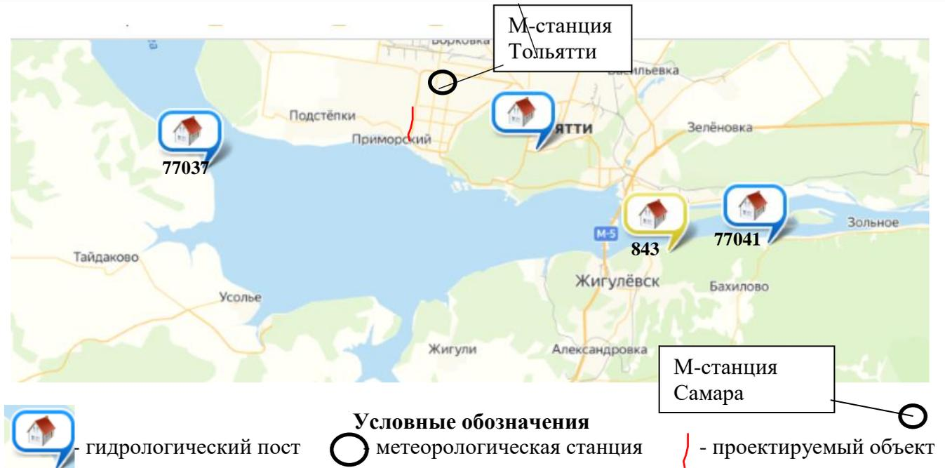
Рисунок 2.1 – Схема гидрологической изученности
