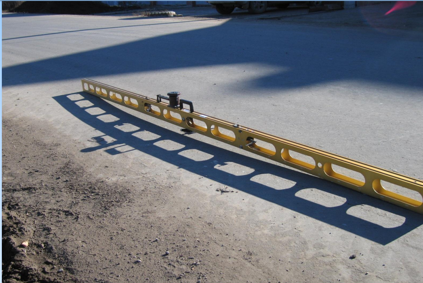
Оценка ровности покрытия с помощью трехметровой рейки
