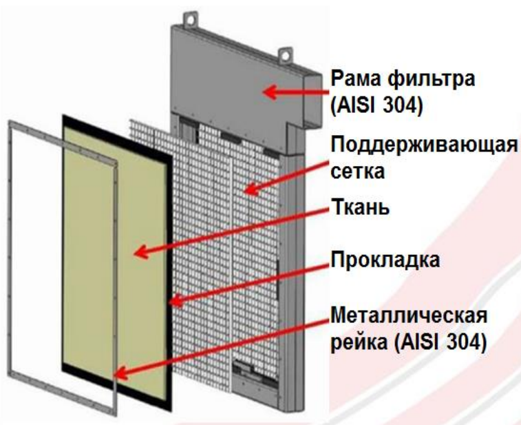
Схема фильтрующего элемента
