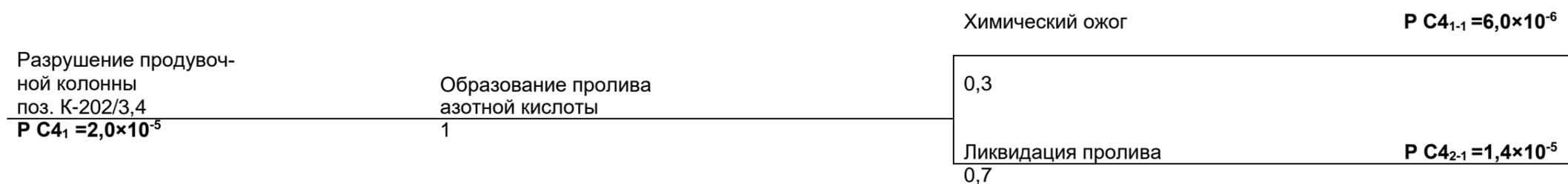
Вероятность полного разрушения продувочной колонны поз. К-202/3,4:
