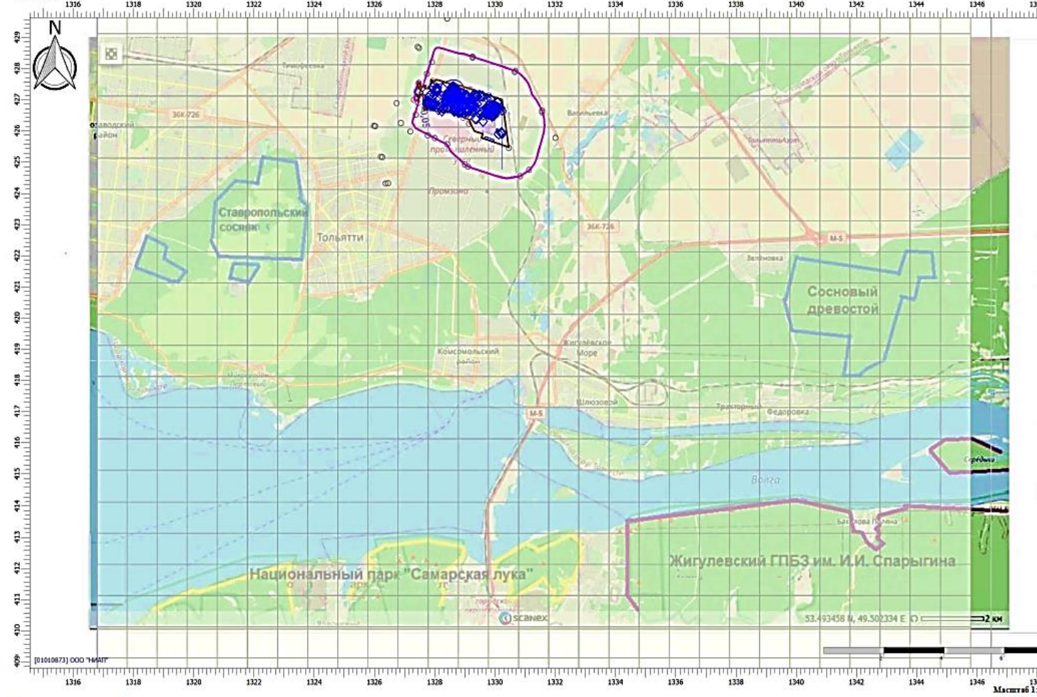
Рис. 2.1.3.11 Карта схема результатов расчётов рассеивания с указанием зоны влияния объекта 0,05 ПДК на период строительства проектируемого объекта для бутылового спирта
