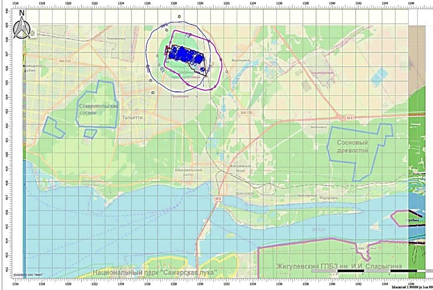
Рис. 2.1.3.19 Карта схема результатов расчётов рассеивания с указанием зоны влияния объекта 0,05 ПДК на период строительства проектируемого объекта для пыли неорганической 70-20% SiO 2
