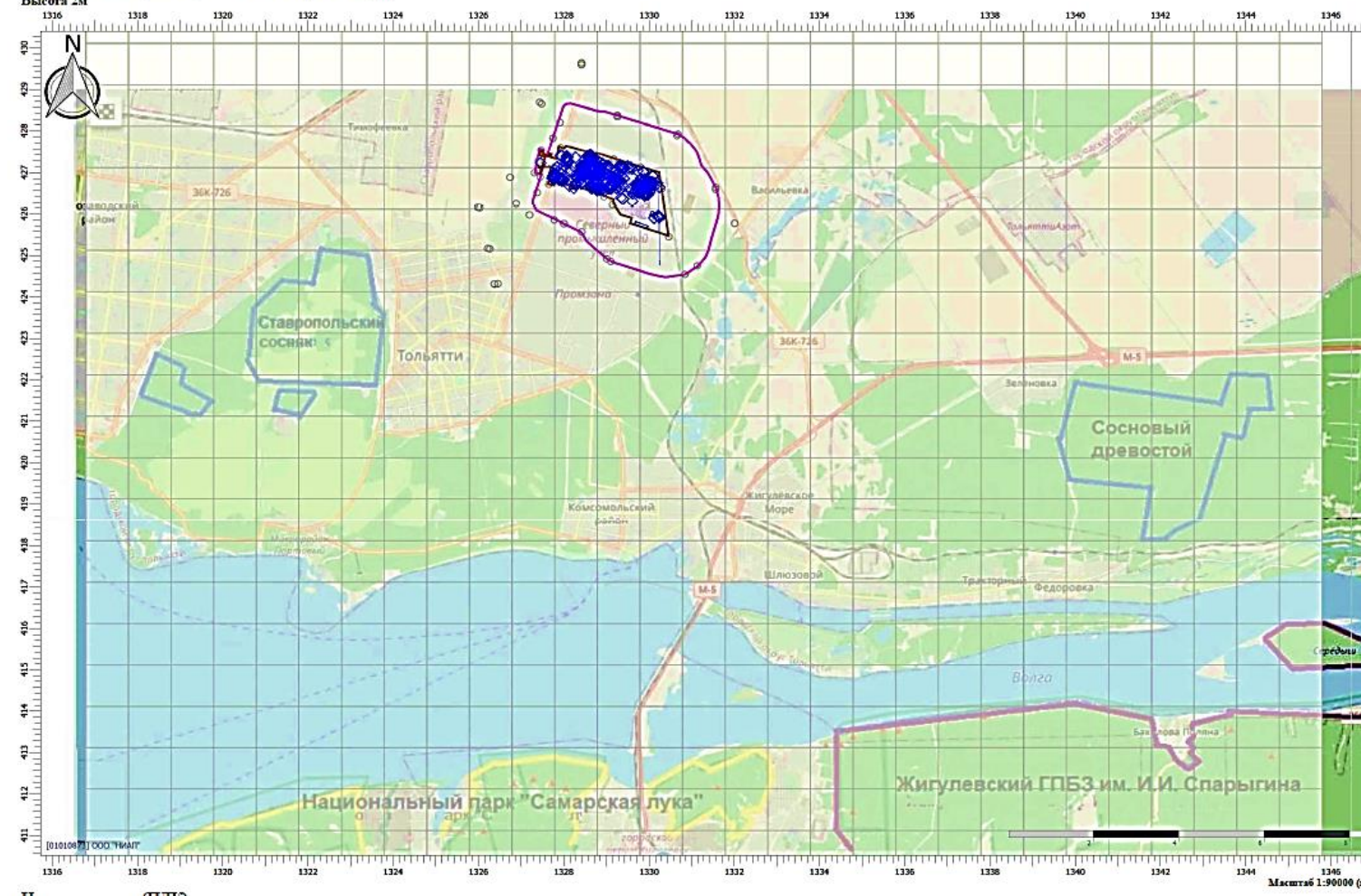
Рис. 2.1.3.15 Карта схема результатов расчётов рассеивания с указанием зоны влияния объекта 0,05 ПДК на период строительства проектируемого объекта для этилендиамина
