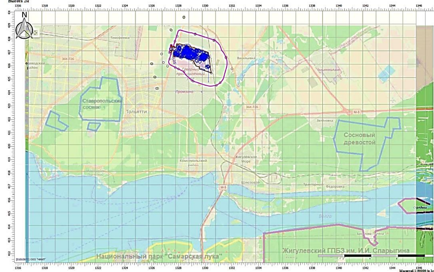
Рис. 2.1.3.18 Карта схема результатов расчётов рассеивания с указанием зоны влияния объекта 0,05 ПДК на период строительства проектируемого объекта для взвешенных веществ
