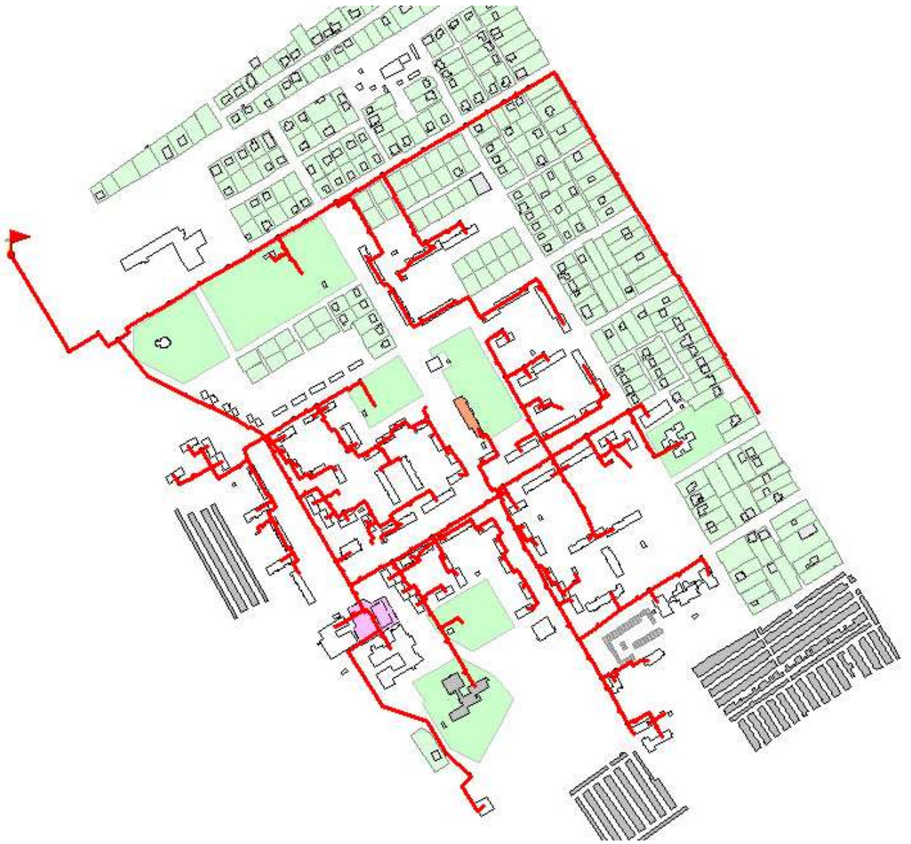
Рисунок 46 – Тепловая сеть от котельной БМК-34
