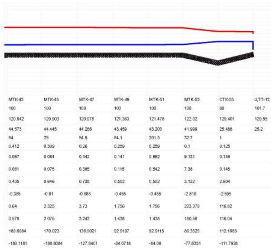
Рисунок 4 – Пьезометрический график от ТоТЭЦ до ЦТП-12 при строительстве новой теплотрассы от ЦОК до Котельной № 2 протяженностью 4,5 км с 2 Ду 1000 мм (в качестве насосной одновременно ЦОК, Котельная № 2).
