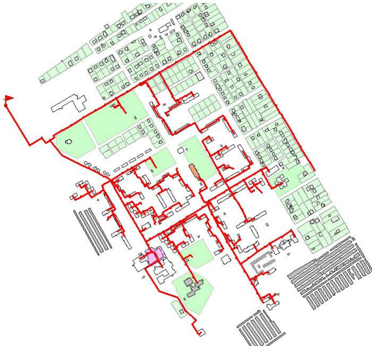
Рисунок 46 – Тепловая сеть от котельной БМК-34
