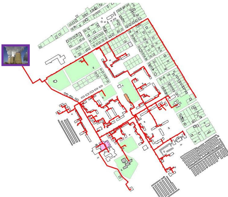
Рисунок 21 – Зона теплоснабжения котельной БМК-34
